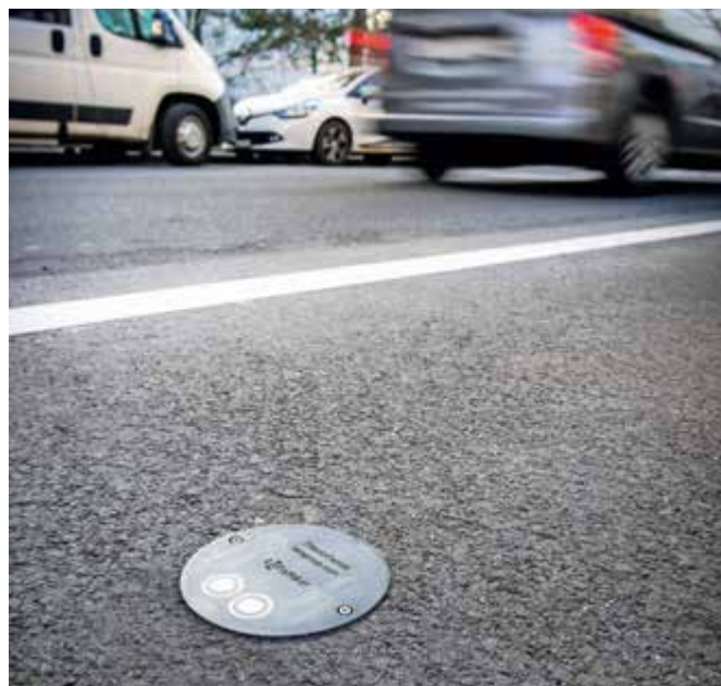
5 | Fahrzeugerkennungssensoren erfassen die Belegung von Parkplätzen. 5 | Capteur de détection de véhicules (source: IEM SA).
