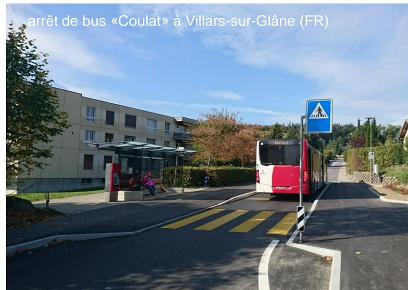
... oser des solutions novatrices (arrêt de bus «bidirectionnel» avec rétrécissement de chaussée au sein de zones 30 par exemple)
